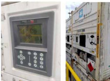
เครื่องทำความเย็นไม่ทำงาน บริษัท SEALAND MAERSK ASIA PTE LTD. เมื่อวันที่ 19 กันยายน 2566
